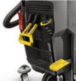
Presión del cabezal de cepillos ajustable
